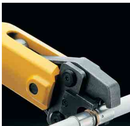
Труба „Coripe“ с прессовым соединением
